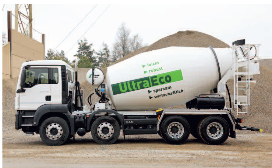
Nowa, ekonomiczna betonomieszarka Ultra Eco. W wersji podstawowej waży 3250 kg i pozwala na transport 8 m 3 betonu (przy 2,35 t/m 3 )
