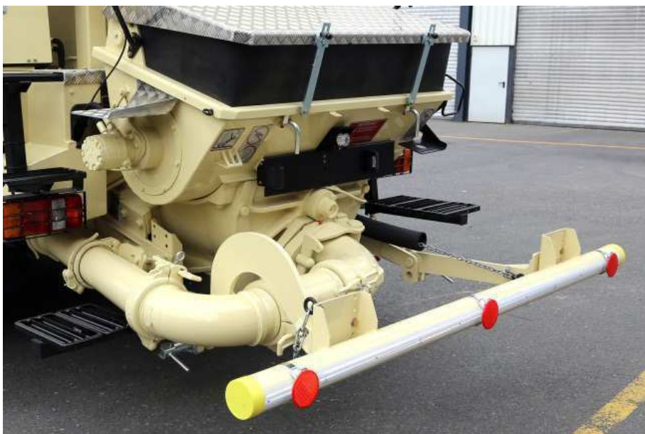
Tylna belka zabezpieczająca podczas jazdy.
