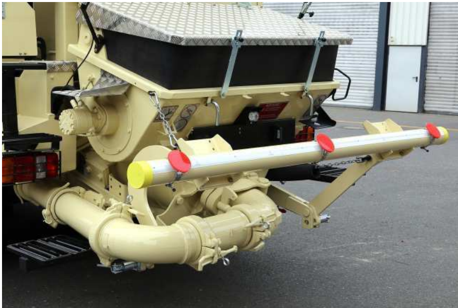
Tylna belka zabezpieczająca podczas pracy maszyny
