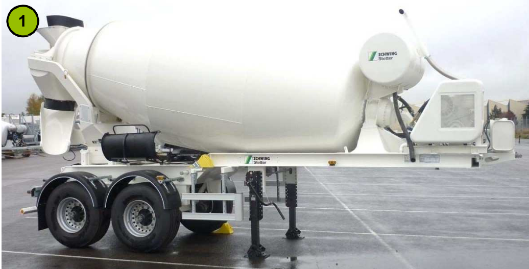
Podpory naczepy: zamontowane na stałe, z regulacją wysokości
