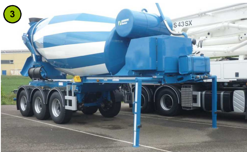
Podpory naczepy: demontowalne, bez regulacji wysokości
