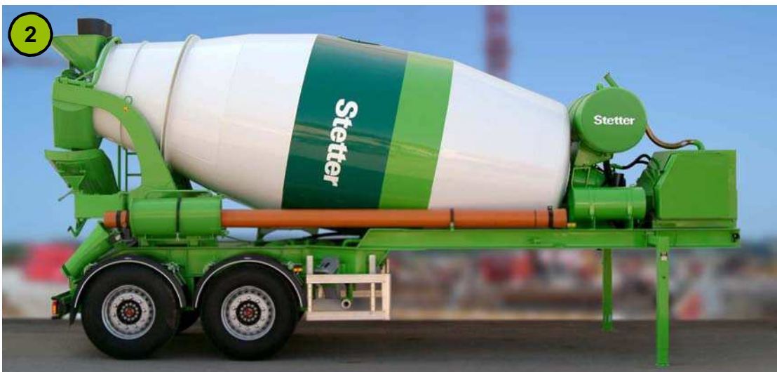
Podpory naczepy: demontowalne, z regulacją wysokości
