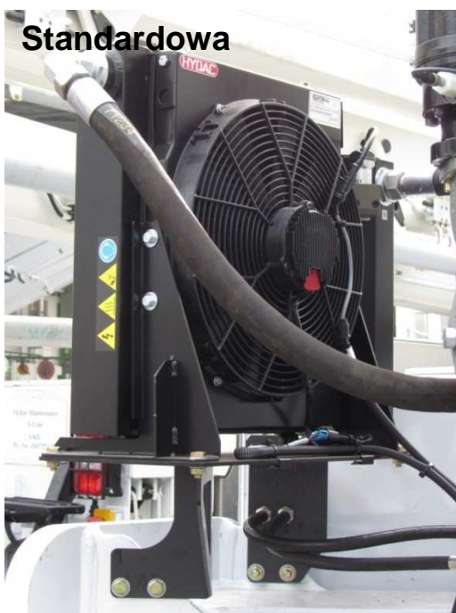
Nowa chłodziwa oleju (Hydac) Wentylator napędzany elektrycznie
