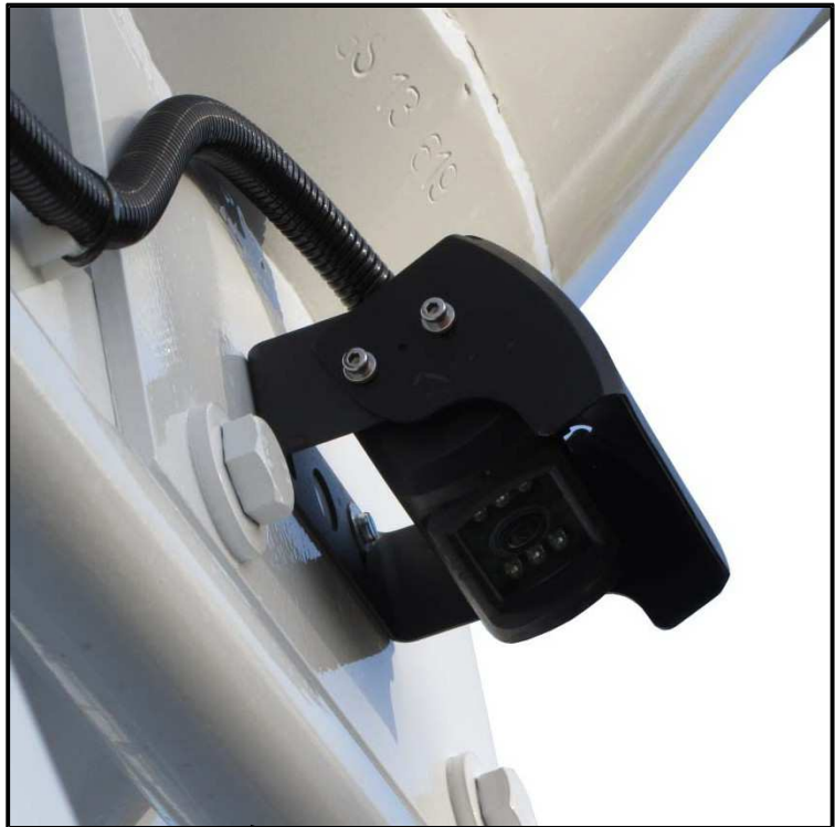
Opcjonalna kamera cofania na betonomieszarce Stetter
