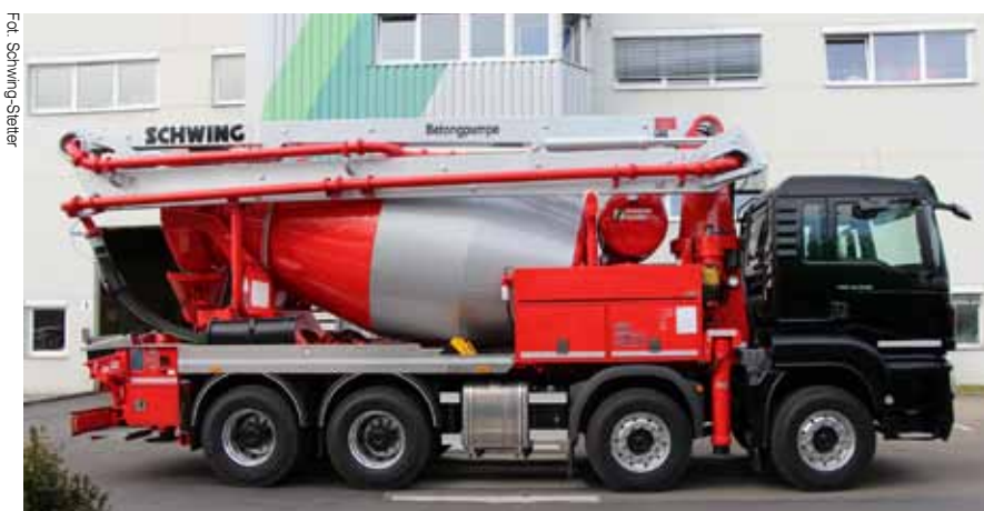
Pompogruszka Schwing-Stetter. Jest połączeniem najnowszej techniki pompowania firmy Schwing z techniką mieszania i transportu betonu firmy Stetter
